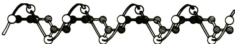
Рис. 2-23. Спиральная структура изотактической полипропиленовой цепи. Метильные группы образуют спираль, показанную в виде пенты.
