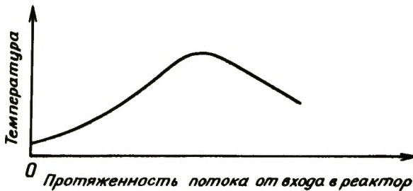
Рис. 4-1. Осевой температурный профиль в реакторе окисления с неподвижным слоем.
