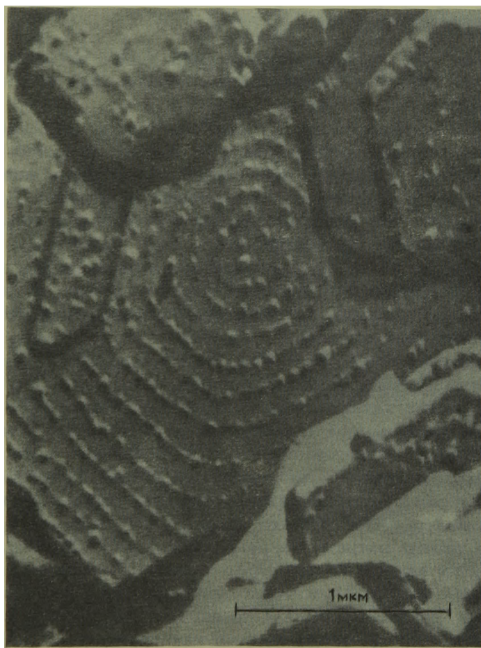
Рис. 2-40. Электронно-микроскопический снимок гексагонального кристалла \alpha - \text{TiCl}_3 . Полагают, что точки представляют собой полипропиленовые цепи, растущие на центрах, которые локализованы вдоль спирали роста кристалла [53].
